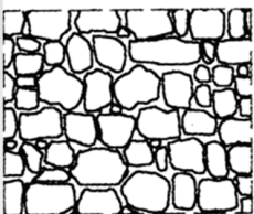
Muratura a sacco
